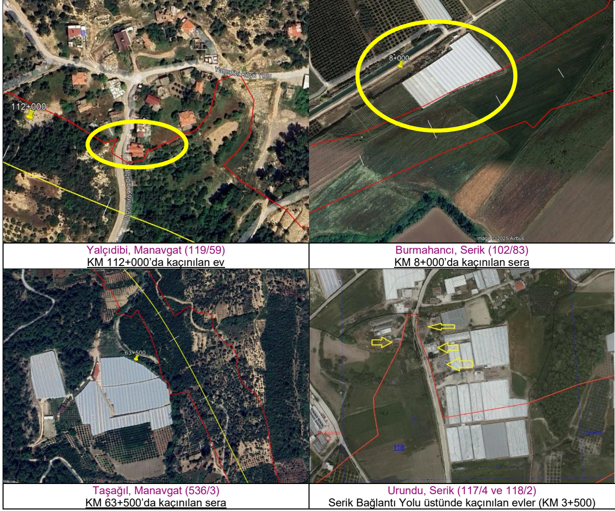
Şekil 2-7. Kamulaştırma Koridoru Sınırlarının Mikro Konumlandırması Üzerinden Kaçınma Örnekleri
